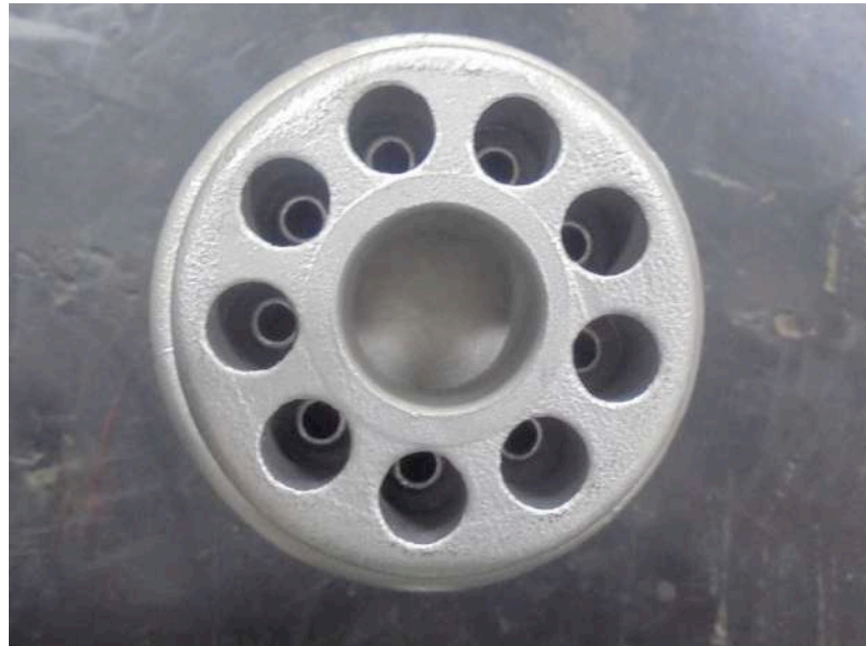
Figura 25 – Visão axial do injetor de vapor IN25M do fornecedor Spirax Sarco para instalação do tanque de água quente
